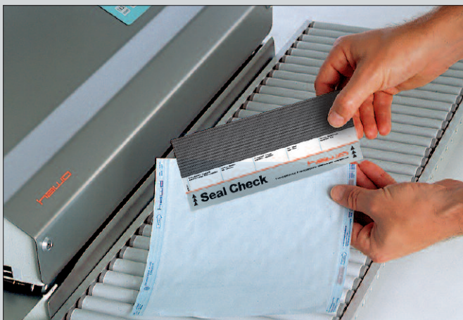
Siegelnahtprüfung mit dem hawotest Seal Check
